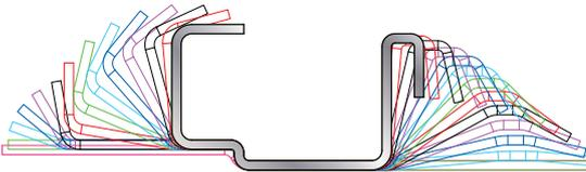
**Machines à profiler pour la déformation de métal à plat vers un profil de section constante**
